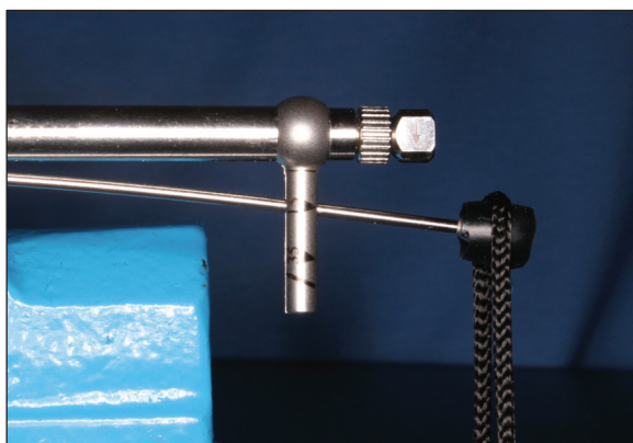
Ryc. 5. Odczyty na skali sprężynowego klucza dynamometrycznego.
