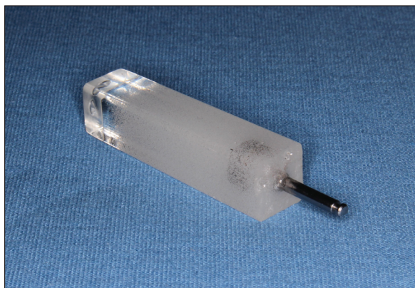
Ryc. 1. Prostopadłościenny blok z żywicy epoksydowej i mandrynu gumki polerskiej.
