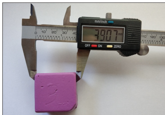
Fig. 2. Dimensions measurement using an electronic vernier caliper. Ryc. 2. Pomiar przy użyciu elektronicznej suwmiarki.
