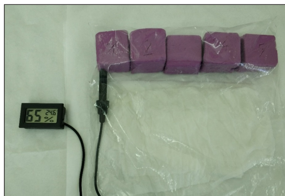
Fig. 3. Temperature and humidity measurement using a hytherograph with moving measuring head. Ryc. 3. Pomiar temperatury i wilgotności przy użyciu termohigrometru z ruchomą głowicą.
