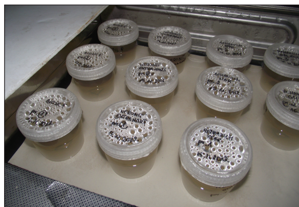
Ryc. 5. Próbkami zamkniętymi w pojemnikach umieszczonych w łaźni wodnej w temperaturze 37°C.
