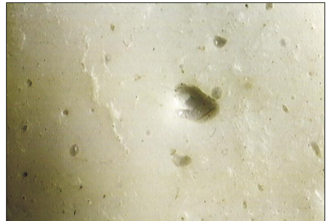
Ryc. 4. Powierzchnia silikonowego materiału elastycznego mieszanego ręcznie. Powiększenie 20x i 40x. Widoczne liczne pęcherzyki powietrza.
