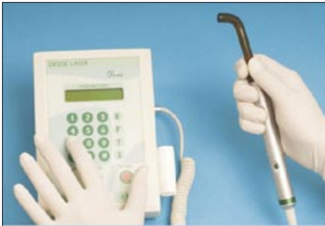
Ryc. 3. Laser diodowy Doris CLT-1106 o długości fali 635 nm.
